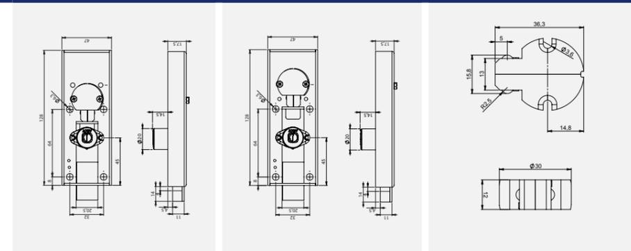
**STRIKER PLATES FOR EP303** **FITTING PLATE FOR EP303**
